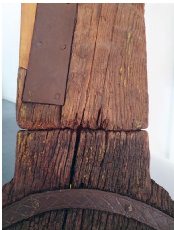
Particolare del taglio con cui il battitore era stato diviso in due parti.
